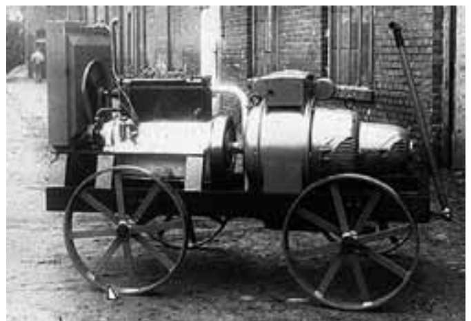
Abb. 1: Schweissgenerator mit Verbrennungsmotor (1928)
