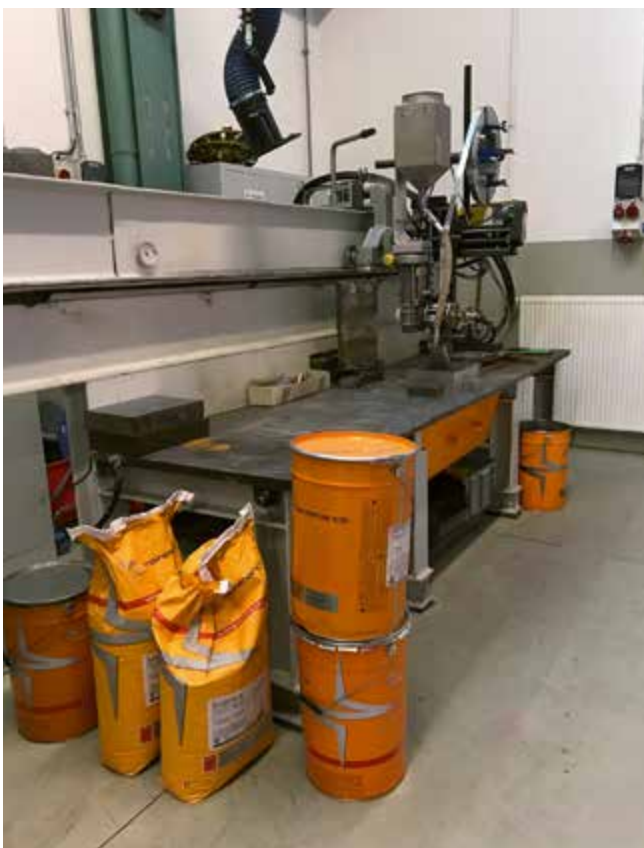
Versuchsstand zur Durchführung von UP- und RES-Kundenversuchen
