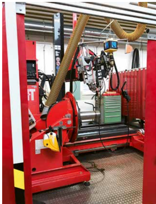
Versuchsstand zur Durchführung von MIG/MAG-Kundenversuchen
