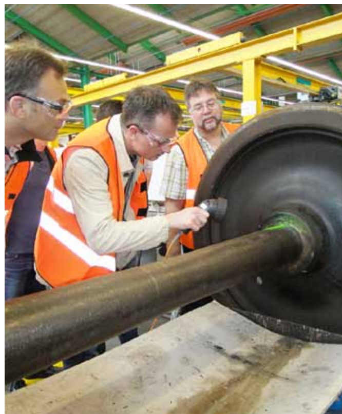
Zerstörungsfreie Prüfung an Hohl-/Vollwellen und an Radreifen
