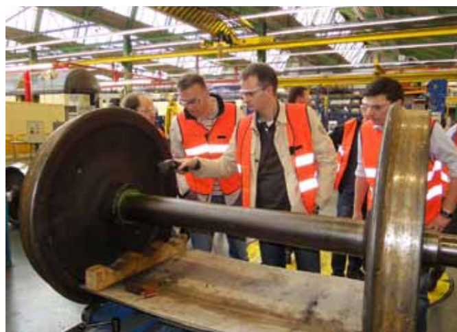
Zerstörungsfreie Prüfung an Hohl-/Vollwellen und an Radreifen
